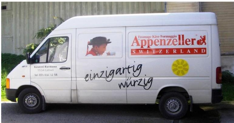
Im weiteren wurde für den Milchtransport von Wolfikon ein VW LT 40 Kastenwagen mit eingebauten 2'000 Liter Milchtank und Messanlage angeschafft.
